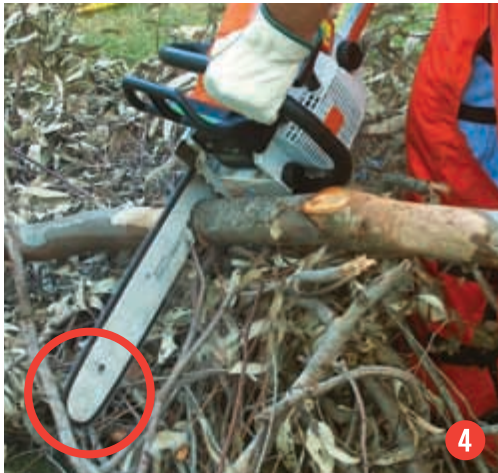
Figura 4 No corte con la punta superior de la barra de la motosierra -su contacto con otras ramas puede ocasionar el retroceso.
